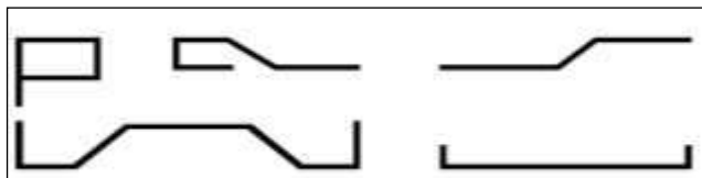
Рис. 5 Формы изгиба арматуры
